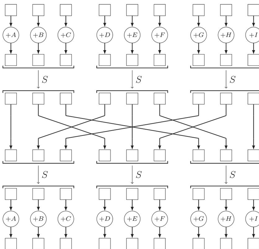
Dans ce circuit, la transformation notée  $S$  prend 3 chiffres en entrée et donne 3 chiffres en sortie. Ci-dessous, Alice a indiqué comment fonctionne la transformation  $S$ .
