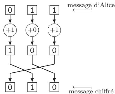
Avec ce circuit, le message 011 est chiffré par 010. Avec le même circuit, le message 110 aurait été chiffré par 101.
